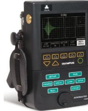
Olympus BondMaster z metodą pitch-catch, MIA (mechanical impedance analysis) oraz resonance modes.
