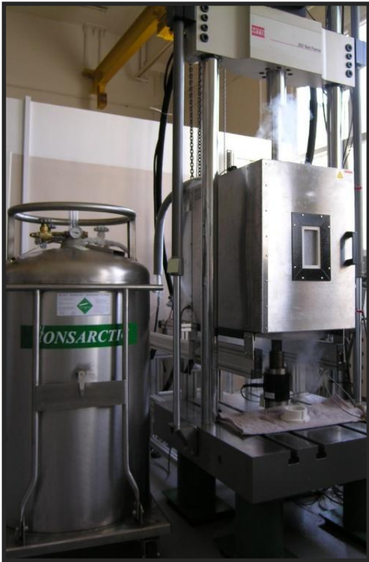
Maszyna MTS 322 z komorą klimatyczną
